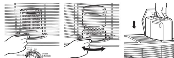
**23** 油タンクに給油してから20分以上待ってしんに灯油が十分に吸い上げられてから点火操作をして、各部がスムーズに動き、正常に燃焼することを確認してください。
