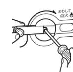
**22** 燃焼筒をしん調節器の上に正しくセットし、ガードを閉じて、油タンクを入れてください。乾電池を電池ケースに⊕⊖を正しく合わせて入れてください。
