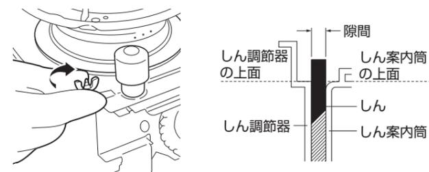
**17** 給油時消火装置のアームを指で押し下げながら、しんを上げてから「感震部」を押して、対震自動消火装置を作動させ、しんがスムーズに確実に下がるかどうか、2~3回確認してください。
