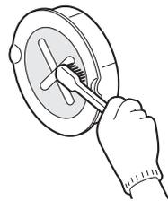
燃焼空気取入口（給気フィルター）の脱着は、矢印の方向に引っばって取りはずします。また、取り付けは燃焼空気取入口（給気フィルター）を相手側部品に押し込みます。
