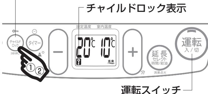
チャイルドロックは、お子様のいたずら操作の防止や、誤って「運転スイッチ」を押しても点火しないようにしたいときに使用します。
