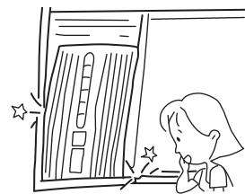
標準取付け枠が極端にさびている、あるいは傾いているなど、据え付けが不安定になっていますか？
