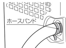
**4** タンクを本体に取り付けます。ホースの先を排水場所へ設置します。タンクを取り付けないと満水ランプが点灯し、運転できません。
