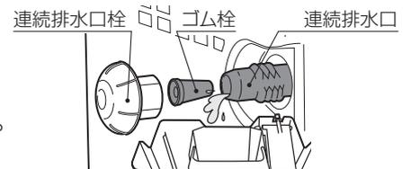
**3** 連続排水口の先端にホースを取り付けます。市販のホース(内径15mm)を連続排水口のネジ部奥まで確実に取り付けます。ホースがゆるい場合は、市販のホースバンドなどで固定してください。
