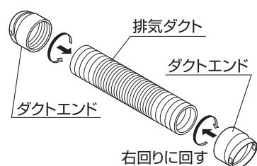
③製品の排気口のツメに、組み合わせた排気ダクトとダクトエンドを挿入し固定してください。
