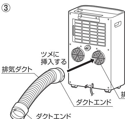
④排気ダクトを適当な長さに伸ばします。排気ダクトを調整するときは、排気ダクトの根元に力がかからないように、必ず手を添えておこなってください。
