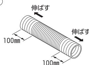
②ダクトエンドを排気ダクトに挿入し、止まるところまで右回りに回して固定してください。
