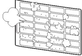
エアーフィルターや熱交換器を掃除する。<br>(25ページの <b>エアーフィルターの掃除</b> を参照して、掃除をしてください。) |
