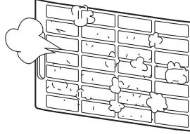
エアーフィルターや熱交換器を掃除する。<br>(22ページの <b>エアーフィルターの掃除</b> を参照して、掃除をしてください。) |
