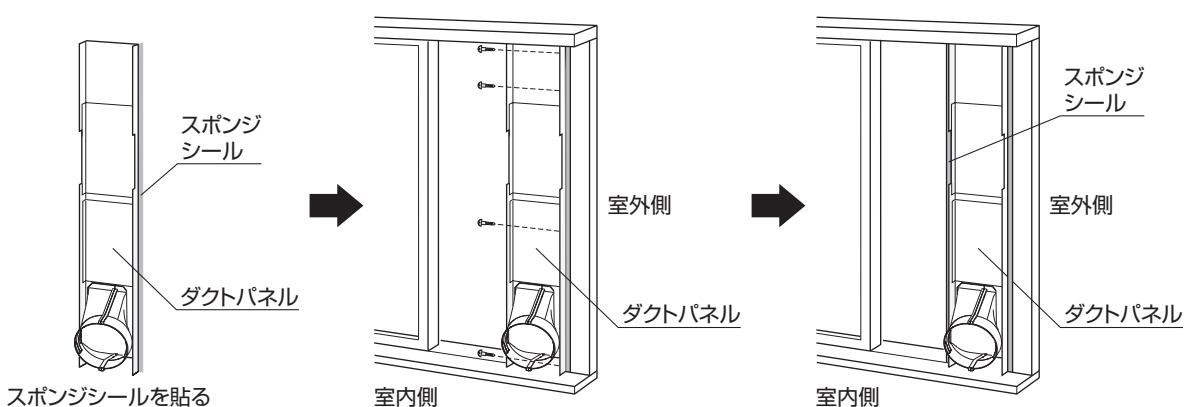
※窓枠(サッシ)に下穴をドリル等で開けてから、組立てたダクトパネルを窓枠(サッシ)に固定してください。
