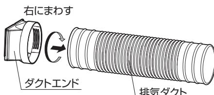
③排気ダクトのダクトエンドがない側を、ダクトパネルにある排気ノズルに挿入して止まるところまで、右まわして固定してください。
