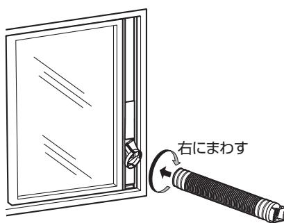
④ダクトエンドにある「TOP」の表示を上にして、本体の排気口の溝に差し込んで、押し下げてください。
