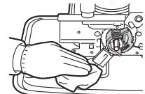
7 油受け・本体を元通り組付け、燃焼筒をしん調節器の上に正しくのせてください。
