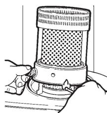
**3 燃焼筒のセットを確認する。**
