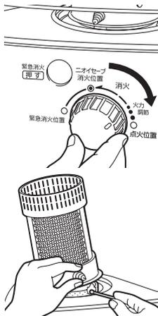
3 燃焼筒のセットを確認する。
