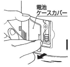
**2** 市販の単二形乾電池(2個)を購入のうえ、電池ケースの⊕ ⊖表示に正しく合わせて取り付けてください。
