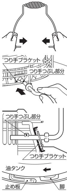
**6** 油タンク底面の脚を、置台の止め板の下に、油タンクを回すようにして押し込んで取り付けてください。
