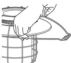
**6** 油タンク底面の脚を、置台の止め板の下に、油タンクを回すようにして押し込んで取り付けてください。
