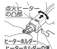
点火ヒーターのフィラメントに、指を触れて変形させないように注意してください。
