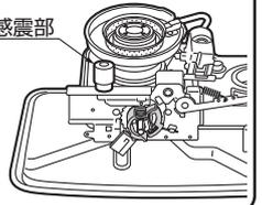
**7 本体を元通りに組付け、燃烧筒をしん調節器の上に正しくのせてください。**
