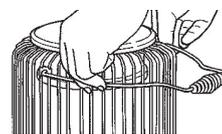
**5** 油タンク底面の脚を、置台の止め板の下に、油タンクを回すようにして押し込んで取り付けてください。
