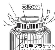
**4** つり手を、正面側から、ガードの両側にあるつり手ブラケットの穴と、天板の両側にある穴を通して取り付けてください。
