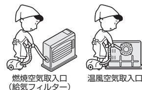
燃焼空気取入口(給気フィルター)
