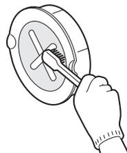
燃焼空気取入口(給気フィルター)の脱着は、矢印の方向に引っかけて取りはずします。また、取り付けは燃焼空気取入口(給気フィルター)を相手側部品に押し込みます。
