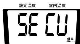
「ピー」音がして、デジタル表示部に「SE CU」が表示され、「人感センサー」が人の動きを感じしなくなつて（「人感センサー ランプ」が消灯）から約30秒間経過すると「人感センサー」が自動的に監視を始めます。
