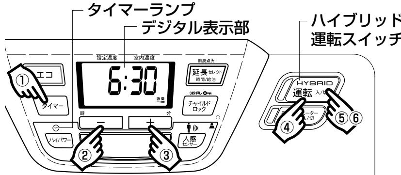
通常、タイマー運転設定時刻の0分から25分前に運転を開始します。このストーブのタイマー運転は、ファジーコントロールで、お部屋の大きさと室温により自動的に運転時刻を決定し、設定時刻には、お部屋を暖かくしておきます。
