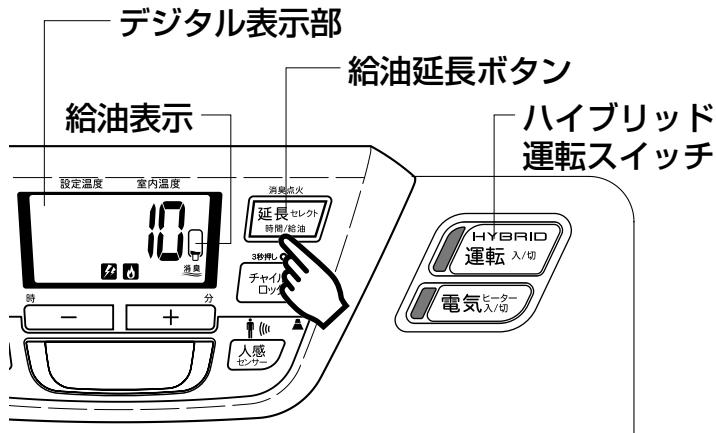
1 油タンクの灯油がなくなると、「」表示が点灯し、「ピー」音が鳴ります。デジタル表示部に残り燃焼時間(分)「」を表示します。
