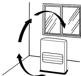
●温風の循環を妨げるものが無い場所に設置してください。 ●外気に接する窓の下や壁面に設置すると効果的です。
