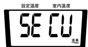
「ピー」音がして、デジタル表示部に「SECU」が表示され、「人感センサー」が人の動きを感知しなくなって(「人感センサーランプ」が消灯)から約30秒間経過すると「人感センサー」が自動的に監視を始めます。
