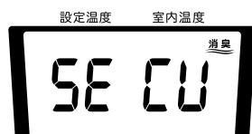
「ピー」音がして、デジタル表示部に「SE CU」が表示され、「人感センサー」が人の動きを感じしなくなつて（「人感センサーランプ」が消灯）から約30秒間経過すると「人感センサー」が自動的に監視を始めます。
