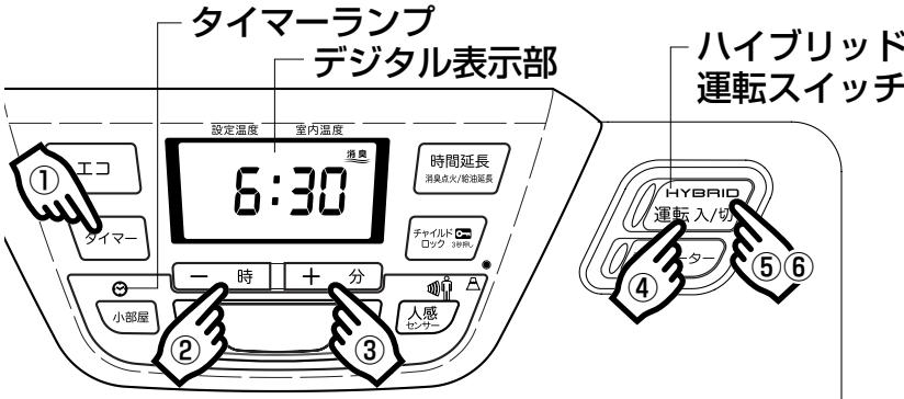
通常、タイマー運転設定時刻の0分から25分前に運転を開始します。このストーブのタイマー運転は、ファジーコントロールで、お部屋の大きさと室温により自動的に運転時刻を決定し、設定時刻には、お部屋を暖かくしておきます。
