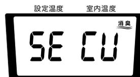
「ピー」音がして、デジタル表示部に「SECU」が表示され、「省エネセンサー」が人の動きを感知しなくなると(「省エネランプ」が消灯)から約30秒間経過すると「省エネセンサー」が自動的に監視を始めます。
