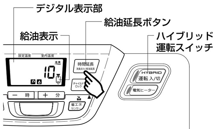
1 油タンクの灯油がなくなると、「
