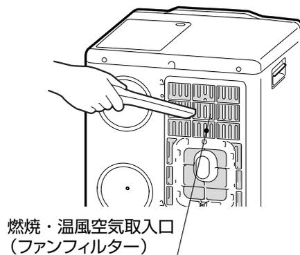
燃焼・温風空気取入口（ファンフィルター）
