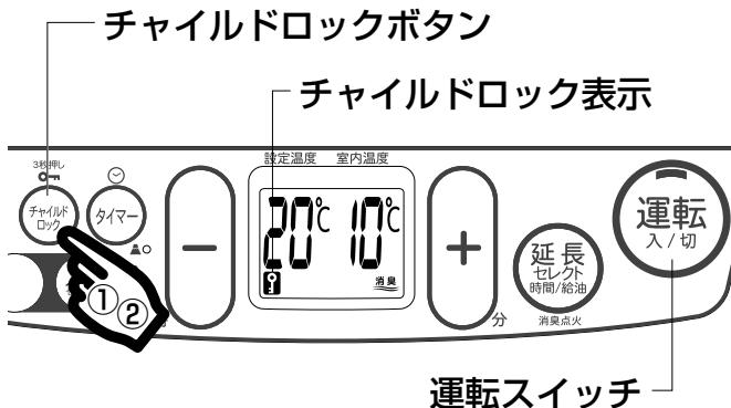
チャイルドロックは、お子様のいたずら操作の防止や、誤って「運転スイッチ」を押しても点火しないようにしたいときに使用します。
