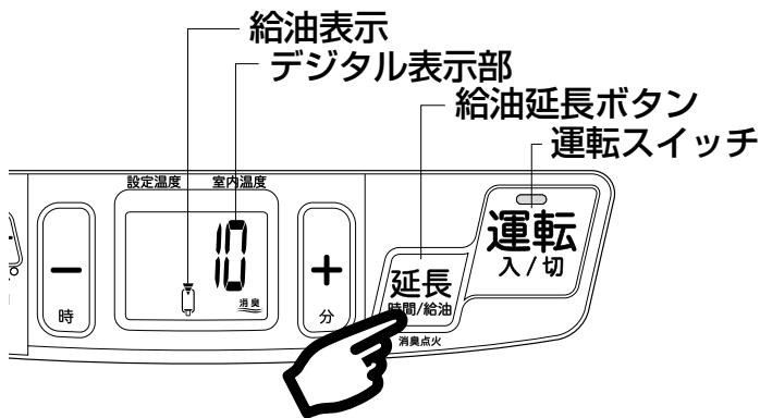
1 油タンクの灯油がなくなると、「」表示が点灯し、「ピー」音が鳴ります。デジタル表示部に残り燃焼時間(分)「」を表示します。
