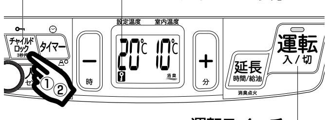
チャイルドロックは、お子様のいたずら操作の防止や、誤って「運転スイッチ」を押しても点火しないようにしたいときに使用します。
