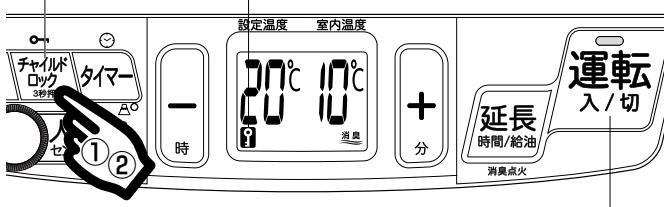
チャイルドロックは、お子様のいたずら操作の防止や、誤って「運転スイッチ」を押しても点火しないようにしたいときに使用します。
