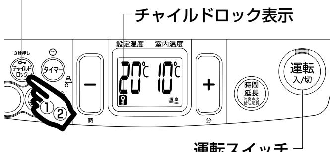
チャイルドロックは、お子様のいたずら操作の防止や、誤って「運転スイッチ」を押しても点火しないようにしたいときに使用します。
