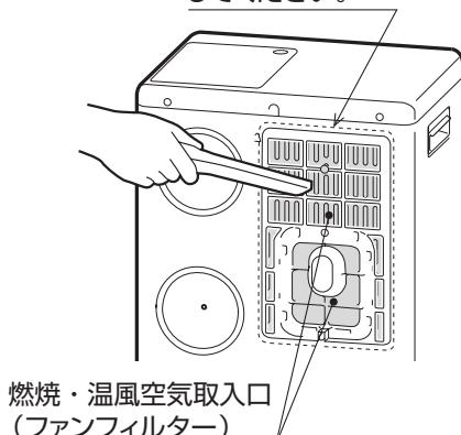
燃焼・温風空気取入口(ファンフィルター)は取りはずさないでください。
