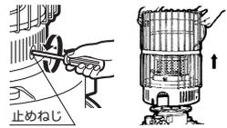
2 しん案内筒上板を止めている、スナップピンを抜き取り、しん案内筒上板を正面より押し上げ、上方に抜き取ってください。
