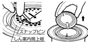
3 点火レバーを片手で「点火」の方向(→)に半分程倒して、もう一方の手でヒーターホルダーを上方よりつまんでください。
