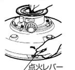
4 片手でヒーターホルダーをつまみながら、点火ヒーターを押し付けながら回して、ヒーターホルダーから抜き取ってください。
