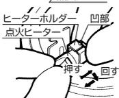
5 片手でヒーターホルダーをつまみながら、新しい点火ヒーターの凸部をヒーターホルダーの溝を通すように入れたら、押しつけながら回して、点火ヒーターの凸部を、ヒーターホルダーの凹部にはめ込んでください。点火ヒーターのフィラメントに、指を触れて変形させないように注意してください。
