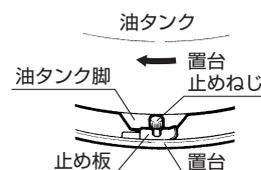
**お願い** 必ず置台を取り付けて使用してください。油タンクの脚などでケガをしないようにしてください。
