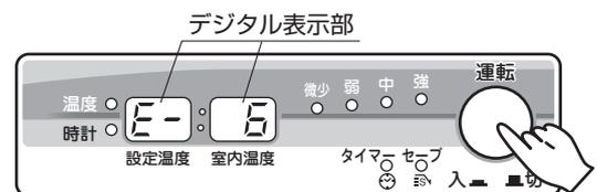
油タンクに灯油があるのに「E- E」が表示するときは、送油経路のつまり、空気たまりが考えられます。このようなときは **空気抜きの方法** (7ページ)や**「定油面器のリセットボタンのセット」**(7ページ)を参照して送油経路の点検をしてください。
