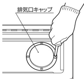
**3** 煙突取付口はストーブの外側に切り欠き部が向くように組み替えてください。
