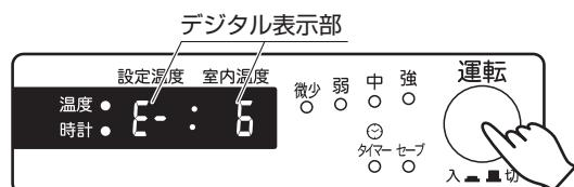
油タンクに灯油があるのに「E- 5」が表示するときは、送油経路のつまり、空気たまりが考えられます。このようなときは「**空気抜きの方法**」(7ページ)や「**定油面器のリセットボタンのセット**」(7ページ)を参照して送油経路の点検をしてください。
