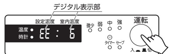
油タンクに灯油があるのに「EE 6」が表示するときは、送油経路のつまり、空気たまりが考えられます。このようなときは「4 使用前の準備」の「給油のしかた」**空気抜きの方法**や「4 使用前の準備」の**点火前の準備と確認**「定油面器のリセットボタンのセット」を参照して送油経路の点検をしてください。
