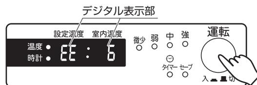
油タンクに灯油があるのに「EE 6」が表示するときは、送油経路のつまり、空気たまりが考えられます。このようなときは「4 使用前の準備」の「給油のしかた」**空気抜きの方法**や「4 使用前の準備」の**点火前の準備と確認**「定油面器のリセットボタンのセット」を参照して送油経路の点検をしてください。
