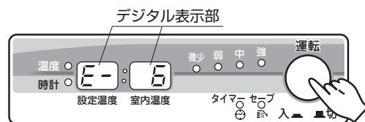
油タンクに灯油があるのに「E- 5」が表示するときは、送油経路のつまり、空気たまりが考えられます。このようなときは「**給油のしかた 空気抜きの方法**」(7ページ)や「**点火前の準備と確認 「定油面器のリセットボタンのセット」**」(7ページ)を参照して送油経路の点検をしてください。
