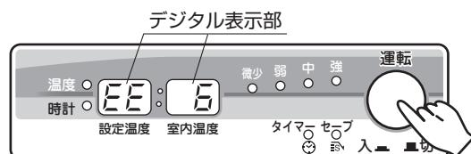
油タンクに灯油があるのに「EE E」が表示するときは、送油経路のつまり、空気たまりが考えられます。このようなときは「4 使用前の準備」の「給油のしかた」**空気抜きの方法**や「4 使用前の準備」の**点火前の準備と確認**「定油面器のリセットボタンのセット」を参照して送油経路の点検をしてください。
