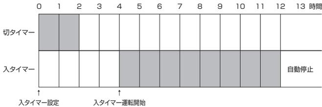
例) 切タイマーを6時間設定後1時間運転したところで、入タイマーを6時間設定した場合(網部が運転している部分)
