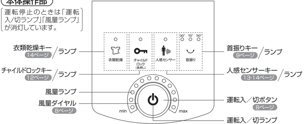
●「衣類乾燥キー」「チャイルドロックキー」「人感センサーキー」「首振りキー」は、タッチパネルキーです。タッチして操作してください。
