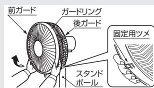
2. 組み立てかた(5・6ページ)と逆の順で羽根と後ガードを分解します。
