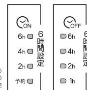
例)切タイマーを2時間設定、入タイマーを2時間設定した場合(網部が運転している部分)
