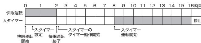
※快眠運転が終了し、停止したときから、6時間後にマイクロリズムで運転を再開します。
