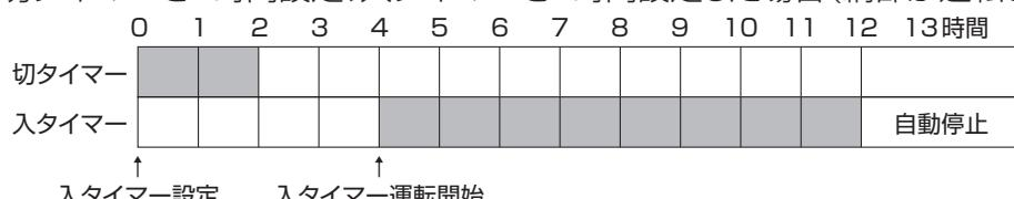
例) 切タイマーを6時間設定後1時間運転したところで、入タイマーを6時間設定した場合(網部が運転している部分)
