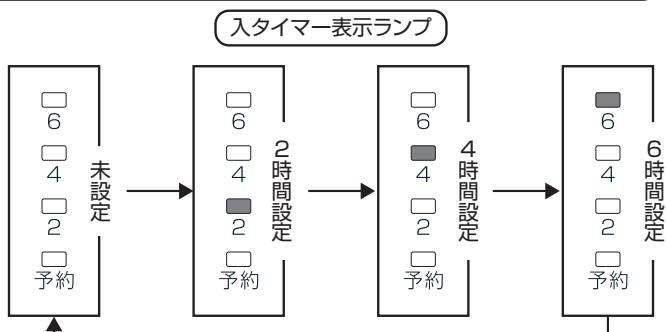
3. 入タイマー設定操作後、約5秒経過すると「入タイマー予約ランプ」が「点灯」し、入タイマーの設定が完了します。
