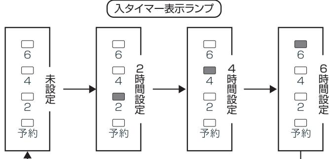
5. 入タイマー設定操作後、約5秒経過すると「入タイマー予約ランプ」が「点灯」し、入タイマーの設定が完了します。
