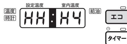
■不完全燃焼通知機能により自動消火したときのエラー表示 (25ページ)
