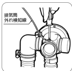
●取付けネジがゆるかったり、排気筒の接続が不完全ですと「E-30」で停止します。
