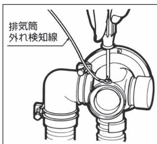
● 取付けネジがゆるかったり、排気筒の接続が不完全ですと「E-30」で停止します。
