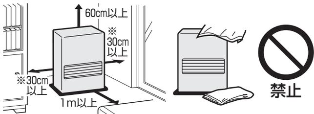
〈可燃物との距離〉※フロントパネルの前方に側壁がある場合、人感センサー誤作動防止のために両側30cm以上離してください。
