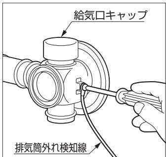
● 取付けネジがゆるかったり、排気筒の接続が不完全ですと「E-30」で停止します。
