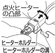
4 本体をかぶせ、外炎筒を正しくしん調節器の上に乗せて、本体の止めねじ3本で取り付けてください。
