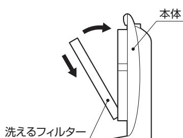
⑦ 本体を横に倒して抗ウイルスフィルターを本体に取り付けてから、プレフィルターのツメ(6箇所)と本体の穴(6箇所)とを合わせて取り付けます。
