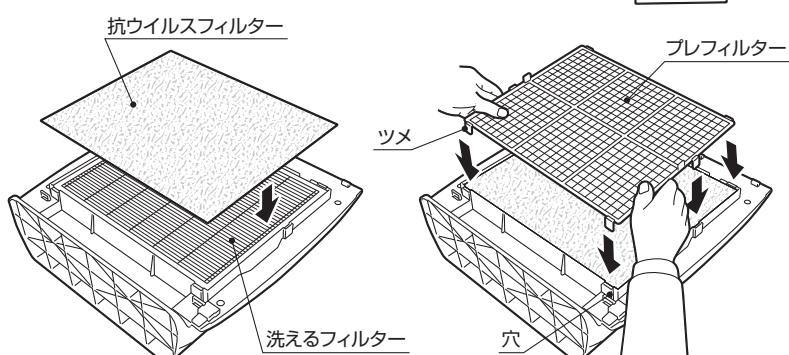
⑧ フロントパネル上部のツメ(4箇所)を本体の勘合部に引っ掛け、製品下部の左右を握るようにして取り付けます。
