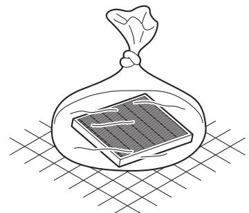
⑥ 洗えるフィルターを袋から取り出し、波形面を本体前側に、不織布面を本体内側になるように本体に取り付けます。
