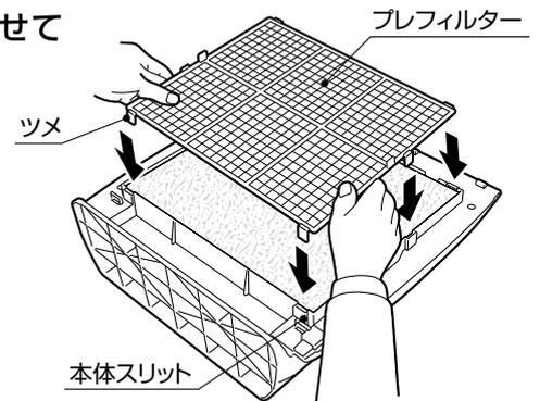
8 フロントパネル上部のツメ(4箇所)を本体の勘合部に引っ掛けて、製品下部の左右を握るようにして取り付けます。
