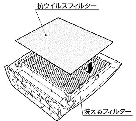
7 プレフィルターのツメ(6箇所)と本体スリット(6箇所)とを合わせて取り付けます。
