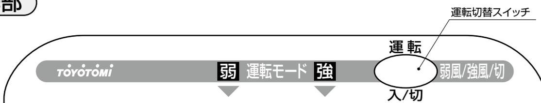
●運転切替スイッチを押して、お好みの運転モードにしてください。(詳しくは8ページ参照)
