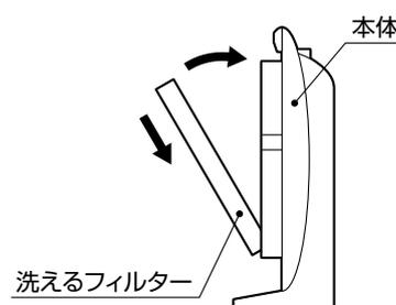
7 本体を横に倒して抗ウイルスフィルターを本体に取り付けてから、プレフィルターのツメ(6箇所)と本体スリット(6箇所)とを合わせて取り付けます。
