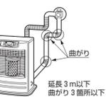
● 標準給排気方式以外にもお部屋の条件によって、排気筒と給気ホースを延長して取り付けることができます。ただし延長限界は 3m 以下で曲がり 3 箇所以下です。
