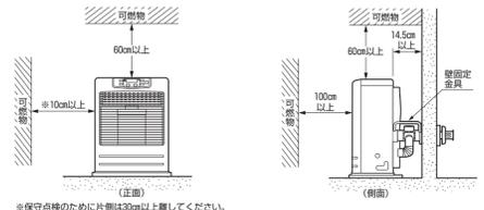
■ 給排気筒トップから周囲の可燃物までの隔離距離は図のようになっています。
