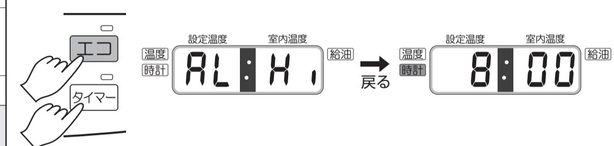
もし、高地設定を解除したいときは、1の操作からやり直してください。ブザー音がしてデジタル表示部に「AL Lo」表示が3秒間点滅し、元の表示に戻れば、高地設定の解除は完了です。
