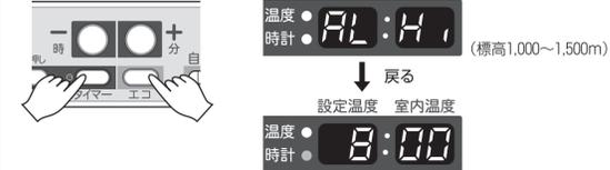
もし、高地設定を解除したいときは、①項の操作からやり直してください。ブザー音がしてデジタル表示部に「AL LO」表示が3秒間減し、元の表示に戻れば、高地設定の解除は完了です。
