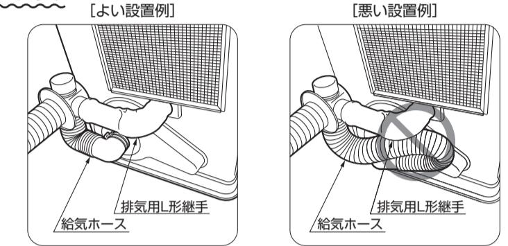
●給気ホース長さは、給排気筒トップの取付け位置によって、カッターナイフ、はさみなどを使用して下図の切断位置で、切って調節してください。
