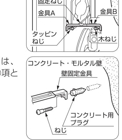
② モルタル、コンクリートの壁に固定する場合は、コンクリート用プラグを壁に打ち込んでから、①頂と同様に壁固定金具で固定してください。
