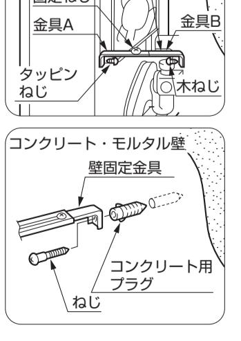
②モルタル、コンクリートの壁に固定する場合は、コンクリート用プラグを壁に打ち込んでから、①項と同様に壁固定金具で固定してください。
