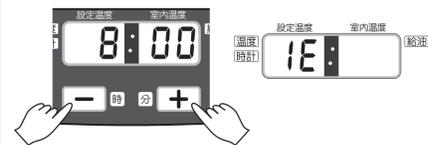
2. デジタル表示部が「1E」表示中にエコボタンとタイマーボタンを同時に3秒間押し続けます。ブザー音がしてデジタル表示部に「AL Hi」表示が3秒間点滅し、元の表示に戻ります。これで高地設定は完了です。一度設定をすれば電源プラグを抜いたり、停電があった場合でも高地設定は保持されます。
