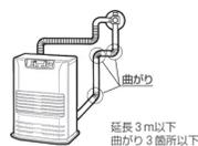
● 標準給排気方式以外にもお部屋の条件によって排気筒と給気ホースを延長して取付けることができます。ただし延長限界は3m以下で曲がり3箇所以下です。
