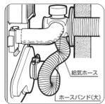
● 給気ホースは、排気用L形継手に接触しないように取り付けてください。
